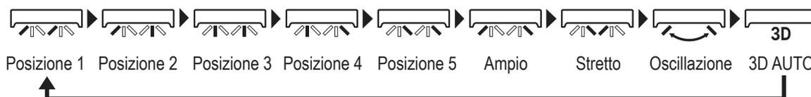
■ Quando dall'app s'imposta il controllo delle alette su “Arresta in qualsiasi posizione” (☞ vedere il manuale dell'app), con i tasti  $\nabla$  /  $\blacktriangle$  si può selezionare “Oscillazione” o “Arresto” per cambiarne la direzione.
