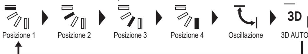
■ Quando dall'app s'imposta il controllo delle alette su “Arresta in qualsiasi posizione” (☰ vedere il manuale dell'app), con i tasti  $\nabla$  /  $\blacktriangle$  si può selezionare “Oscillazione” o “Arresto” per cambiarne la direzione. Nei modelli FDK provvisti di aletta a regolazione orizzontale è possibile selezionare anche la modalità “3D automatico”.
