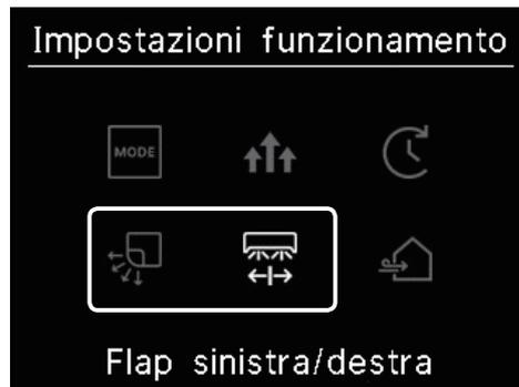
Se non è collegata alcuna unità interna provvista di aletta a regolazione orizzontale ma anche solo una provvista di aletta a regolazione verticale, solo quest'ultima è regolabile.
