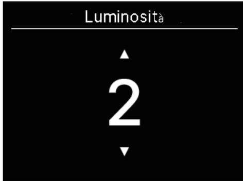
2 Appare la schermata "Luminosità". Qui, con  $\nabla / \blacktriangle$  è possibile regolare l'intensità di retroilluminazione dello schermo.
