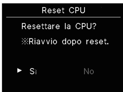
Permette di resettare (allo stato di ripristino alimentazione) il microcomputer delle unità interne ed esterne collegate.
