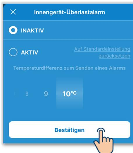
Wenn Sie „Aktiv“ auswählen, wählen Sie den Temperaturunterschied von der Soll-Temperatur aus, um einen Alarm im Bereich von 5 °C bis 10 °C auszulösen (in 1-°C-Schritten).
