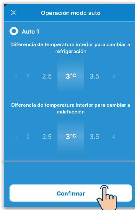
Auto 1: El frío y el calor se conmutan en función de la diferencia de temperatura entre la temperatura de consigna y temperatura interior.
