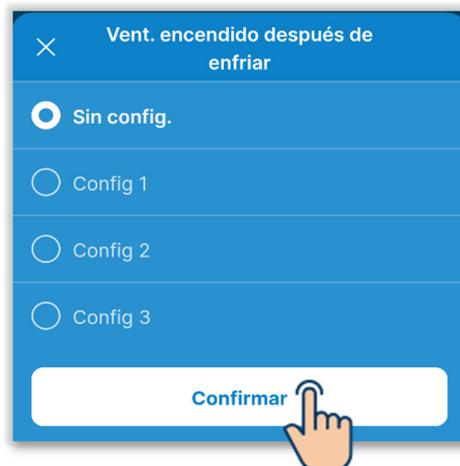
Sin config.: No hay funcionamiento residual del ventilador
