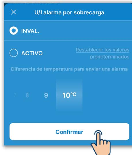
Si selecciona «Activo», seleccione la diferencia de temperatura con respecto a la temperatura de consigna para disparar una alarma en un rango de 5 °C a 10 °C. (Con incrementos de 1 °C)
