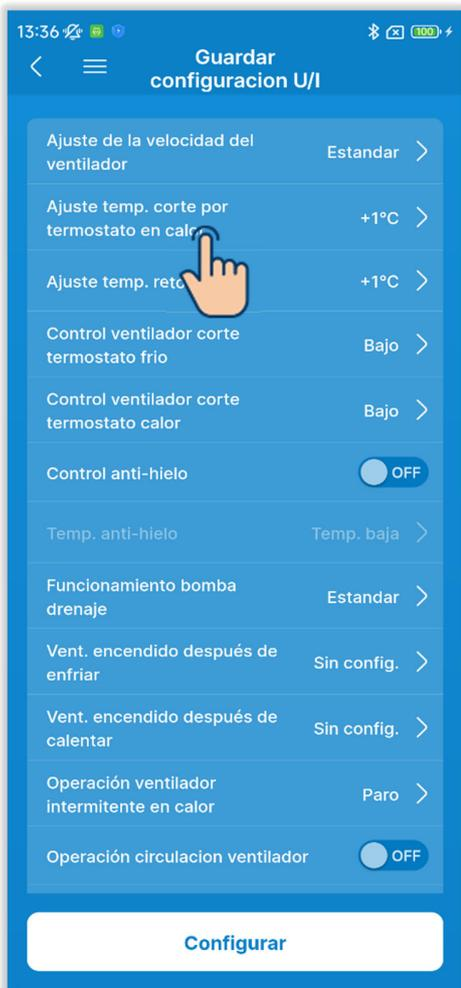
② Configure el ajuste de la temperatura interior de calor.
