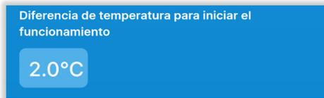
El control de reserva de capacidad se realiza para las unidades interiores con direcciones más recientes (hasta 3 unidades). Si la diferencia de temperatura entre la temperatura de consigna y la temperatura interior supera el valor fijado, el número de unidades en funcionamiento cambia de 1 a 2. Si la diferencia de temperatura es más del doble del valor fijado, el número de unidades en funcionamiento cambia a 3.
