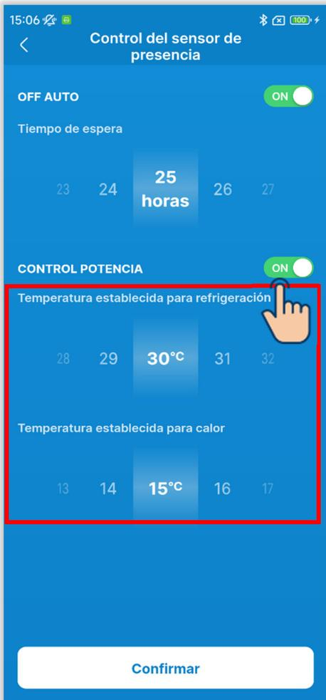
Si activa la opción, configure la temperatura de consigna en modo de frío o la temperatura de consigna en modo de calor en el siguiente rango. (Con incrementos de 1 °C)
