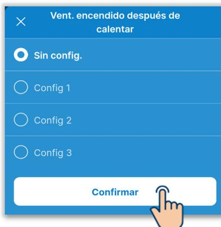
Sin config.: No hay funcionamiento residual del ventilador
