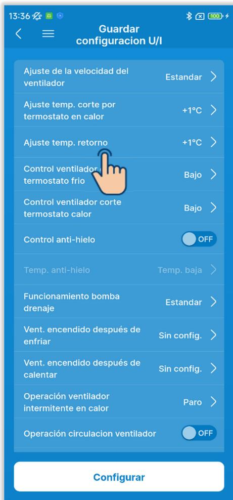
③ Configure el ajuste de temperatura de retorno.
