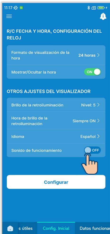
Toque el botón de conmutación para activar o desactivar el sonido de funcionamiento.
