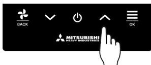
Tippen Sie  $\nabla$  /  $\blacktriangle$  auf die Taste, um die eingestellte Temperatur zu senken/zu erhöhen.
