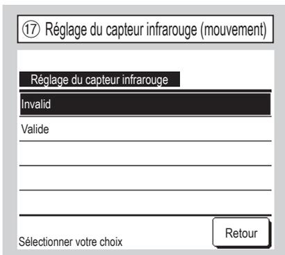
Sélectionner  /  pour le capteur infrarouge de l'unité intérieure connectée à la télécommande.
