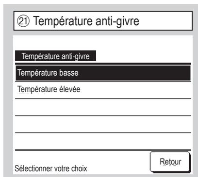
Sélectionner la température de contrôle antigel.
