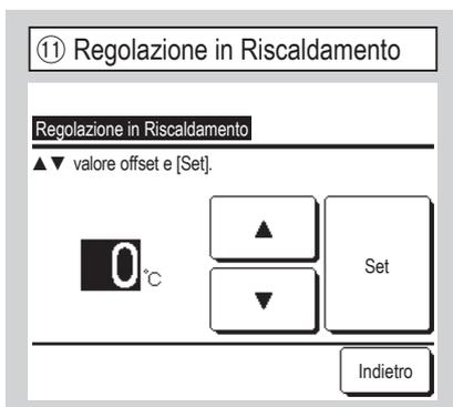
La temperatura di funzionamento del Sensore R/C durante il riscaldamento può essere corretta.
