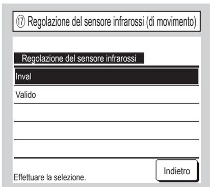
Selezionare   per il sensore a infrarossi dell'unità interna collegata al filocomando.
