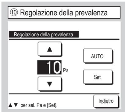
Ciò può essere effettuato in caso di collegamento di Unità Interna di tipo Canalizzabile, provvista di funzione di regolazione della prevalenza. Selezionare la prevalenza esterna e premere il pulsante **Set**.
