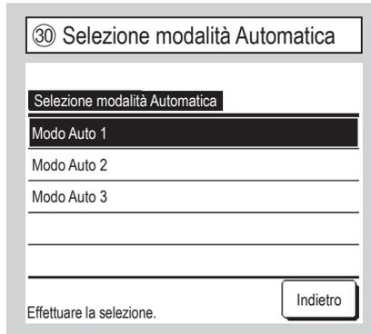
**Modo Auto 1** La commutazione tra Raffrescamento e Riscaldamento si basa sulla differenza tra la temperatura impostata e la temperatura ambiente.
