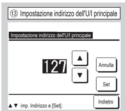
In caso di modelli della Serie Multi (KX), è possibile far sì che le Unità Interne Secondarie seguano la modalità (Riscaldamento, Raffrescamento) dell'Unità Interna Principale. Impostare l'indirizzo dell'U/I Principale alle U/I Secondarie che dovranno seguire l'Unità Interna Principale.
