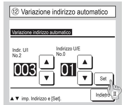
In caso di modello della Serie Multi (KX), gli indirizzi delle Unità Interne registrate mediante impostazione di indirizzo automatico, possono essere modificati tramite questa funzione. Questa funzione cambia l'indirizzo U/E per ogni U/I. Selezionare un indirizzo di U/I e:
