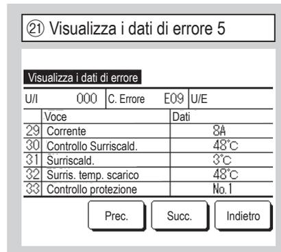
Vengono visualizzati i dati di funz. ottenuti appena prima dell'apparizione dell'errore.
