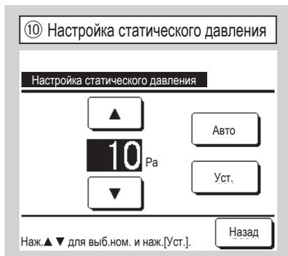
Статическое давление регулируется в случае подключения к UI типа воздуховода с функцией регулирования внешнего статического давления. Выберите внешнее статическое давление и нажмите кнопку .
