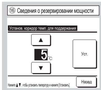
Разница между начальной температурой для изменения между одним блоком и двумя блоками для резервирования мощности и температурой в помещении установлена. Температуру можно задать в диапазоне от 2 до 5°C с шагом в 1°C. После установки температуры нажмите  для временной установки. После временной настройки вернитесь на экран функции резервирования В/Б и нажмите .
