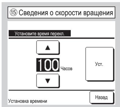
В функции чередования В/Б задается таймер для замены работы двух внутренних агрегатов. Таймер может быть настроен в диапазоне от 10 до 990 часов с шагом в десять часов. После установки времени нажмите  для временной установки. После временной настройки вернитесь на экран функции резервирования В/Б и нажмите .
