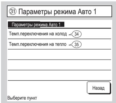
[Установка температуры - Переключение температуры на охлаждение] < [Температура рециркуляционного воздуха] ⇒ Режим работы: Охл-е
