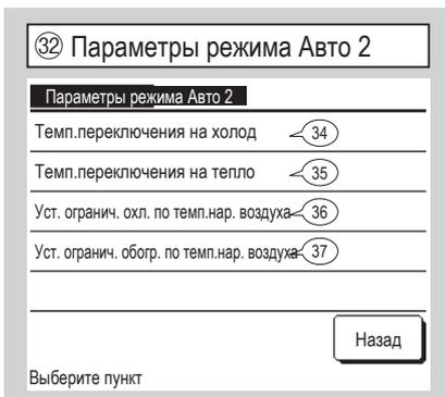
"[Установка температуры - Переключение температуры на охлаждение] < [Температура рециркуляционного воздуха]" и "[Наружная температура, охлаждение] < [Температура наружного воздуха]" ⇒ Режим работы: Охл-е
