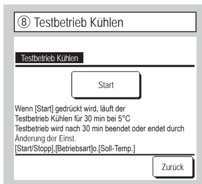
Diese Funktion steht zur Verfügung, wenn der Kühlbetrieb gestoppt wurde. Wenn die Raumtemperatur zu niedrig ist, um „Testbetrieb Kühlen“ zu starten, läuft das Gerät 30 Minuten lang und senkt die Solltemperatur auf 5 °C.
