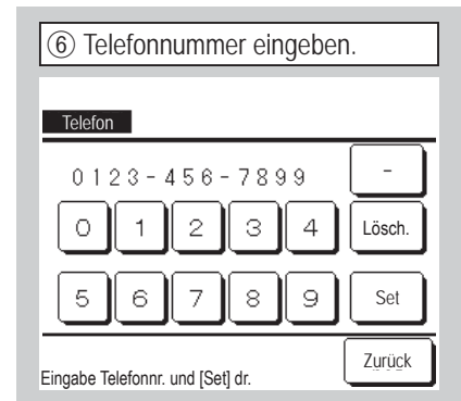
Telefonnummer der Firma, bestehend aus bis zu 13 Zeichen, eingeben und die Schaltfläche drücken.
