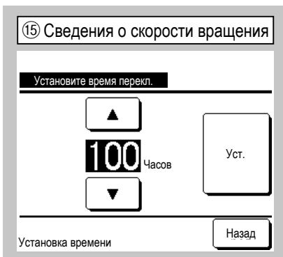
В функции чередования В/Б задается таймер для замены работы двух внутренних агрегатов. Таймер может быть настроен в диапазоне от 1 до 999 часов с шагом в десять часов. После установки времени нажмите **Уст.** для временной установки. После временной настройки вернитесь на экран функции резервирования В/Б и нажмите **Ввод**.
