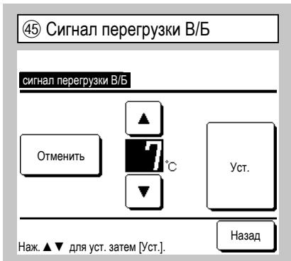
Если температура в помещении отличается от температуры настройки в течение 30 минут после начала работы, то с внешнего выхода (CNT-5) передается сигнал о перегрузке.
