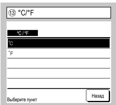
Выберите единицу измерения температуры, отображаемой на ПДУ.
