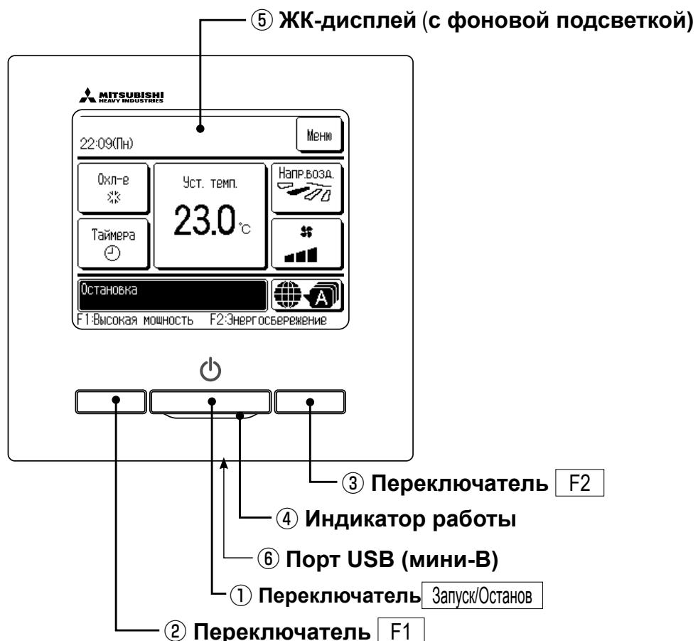
Система с сенсорной панелью, срабатывающая при касании пальцем ЖК-дисплея, применяется для любых действий, кроме ① Пуск/стоп, ② переключатели F1 ③ F2.
