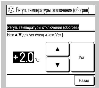
Отрегулируйте температуру для определения включения или не включения терmostата во время операции обогрева. Регулируемый диапазон 0°C / +1°C / +2°C / +3°C.
