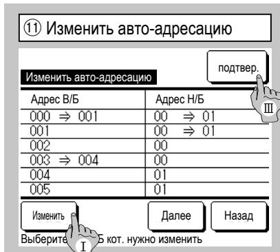
В моделях Multi series (KX) адреса В/Б, зарегистрированные методом настройки авто-адреса, могут быть изменены с помощью этой функции. Данная функция позволяет изменить адрес OU для каждого внутреннего агрегата. Выберите внутренний агрегат и
