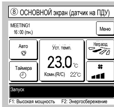
Если сенсор ПДУ включен, на ОСНОВНОМ экране отображается сообщение «Комн.(R/C) ○ °C».
