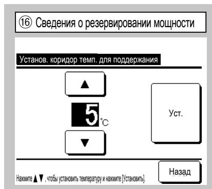
Разница между начальной температурой для изменения между одним блоком и двумя блоками для резервирования мощности и температурой в помещении установлена. Температуру можно задать в диапазоне от 2 до 5°C с шагом в 1°C. После установки температуры нажмите **Уст.** для временной установки. После временной настройки вернитесь на экран функции резервирования В/Б и нажмите **Ввод**.
