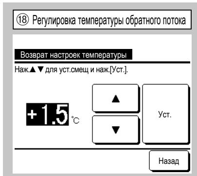
Регулирует температуру определения главного температурного датчика обратного воздуха. Регулируемый диапазон -2°C / -1.5°C / -1°C / 0°C / +1°C / +1.5°C / +2°C.
