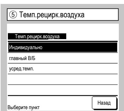
Правило Thermo применяется на основании температуры, выявленной температурным датчиком рециркуляционного воздуха, установленным на внутреннем агрегате (В/Б). Когда к одному блоку ПДУ подключено несколько внутренних агрегатов, то можно выбрать температуру рециркуляционного воздуха, применяемую к правилу thermo.
