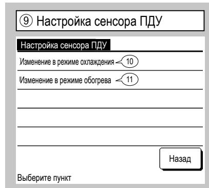
Можно отрегулировать температуру обнаружения для датчика ПДУ.
