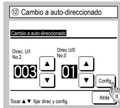
En el caso de modelos de la serie Multi (KX), esta función permite cambiar las direcciones de unidades interiores registradas con el método de configuración auto-direccionado.
