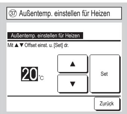
Außentemperatur für Heizbetrieb mit Auto 2 und Auto 3 festlegen. Die Temperatur kann auf 10 °C bis 22 °C eingestellt werden.
