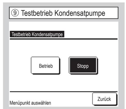
Die Kondensatpumpe kann unabhängig betrieben werden.
