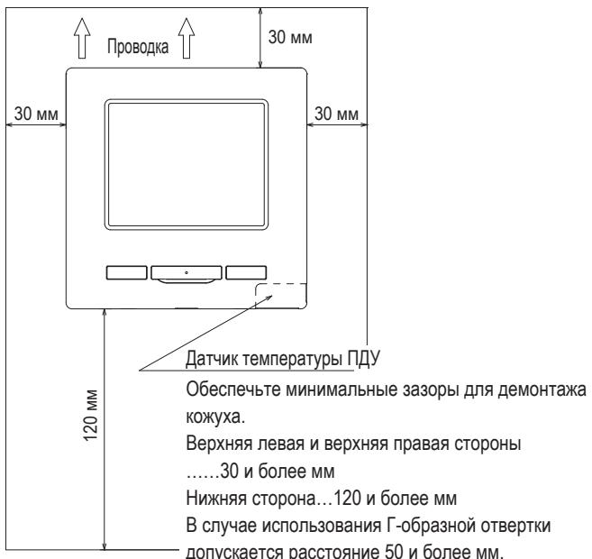
Выполните установку и электромонтажные работы для дистанционного контроллера в следующем порядке.
