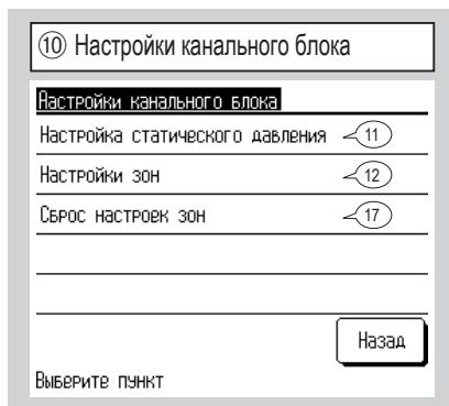
**Настройка статического давления:** Выполнение регулировки наружного статического давления для канального блока.
