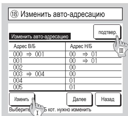
В моделях Multi series (KX) адреса В/Б, зарегистрированные методом настройки авто-адреса, могут быть изменены с помощью этой функции.
