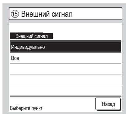
Задайте диапазон внешнего входного сигнала, получаемого через канал управления (CNT) одного внутреннего агрегата (IU), для нескольких внутренних агрегатов, образующих одну систему.
