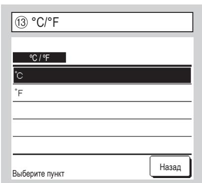
Выберите единицу измерения температуры, отображаемой на ПДУ.
