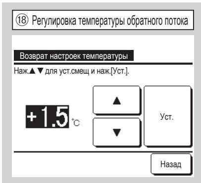
Регулирует температуру определения главного температурного датчика возвратного воздуха. Регулируемый диапазон -2°C / -1.5°C / -1°C / 0°C / +1°C / +1.5°C / +2°C.
