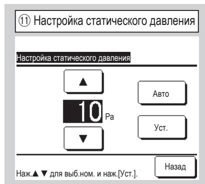
Статическое давление регулируется в случае подсоединения к UI типа воздуховода с функцией регулирования внешнего статического давления. Выберите внешнее статическое давление и нажмите кнопку Уст..
