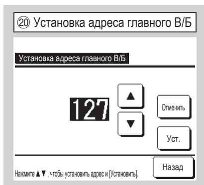
В моделях серии Multi (KX) работу внутренних вспомогательных агрегатов (Вспом. В/Б) можно настроить так, чтобы они придерживались рабочего режима (обогрев, охлаждение) главного внутреннего агрегата (Главн. В/Б). Установите адрес главного В/Б и вспомогательных В/Б. Для вспомогательных В/Б, на которые установлен адрес главного В/Б, используйте настройки главного В/Б.
