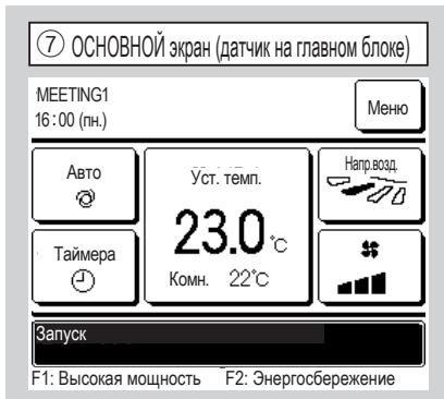
Если сенсор ПДУ отключен, на ОСНОВНОМ экране отображается сообщение «Комн. ○ °C».
