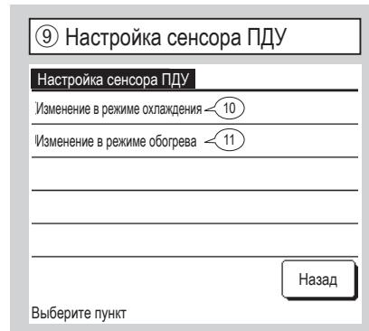
Можно отрегулировать температуру обнаружения для датчика ПДУ.
