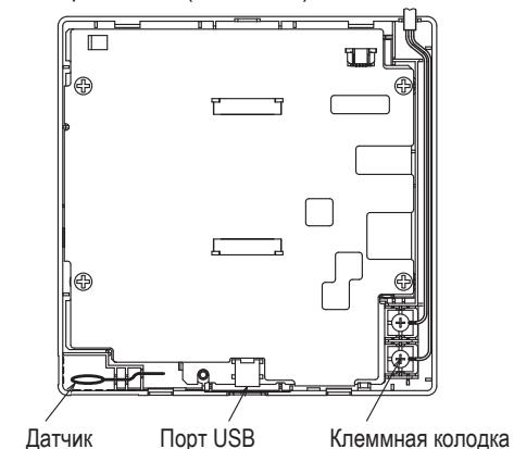
Чтобы разобрать ранее собранный корпус ПДУ на верхнюю и нижнюю части
