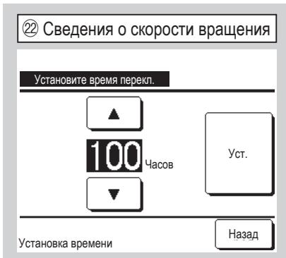
В функции чередования В/Б задается таймер для замены работы двух внутренних агрегатов. Таймер может быть настроен в диапазоне от 1 до 999 часов с шагом в один час. После установки времени нажмите **Уст.** для временной установки. После временной настройки вернитесь на экран функции резервирования В/Б и нажмите **Ввод**.
