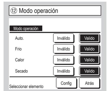
o  pueden configurarse para cada modo de operación. Si se deshabilita el modo de calefacción o refrigeración, también se desactiva el modo automático.
