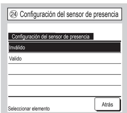
Seleccione **Valido** / **Inválido** para el sensor de presencia de la unidad interior conectada al M/D.
