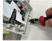
Von beiden Seiten vertikal einschneiden (A)
