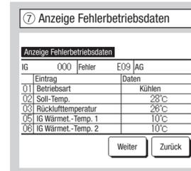
Angezeigt werden die Betriebsdaten, die kurz vor dem Eintreten eines Fehlers eingegangen sind. Die einzelnen Betriebsdaten, die angezeigt werden, sind in der Tabelle rechts aufgeführt.
