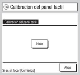
Permite corregir diferencias entre la pantalla y la posición de contacto. Toque la parte central de [+] y compruebe si hay alguna desviación. **Confirm** ⇒ Calibración completada.
