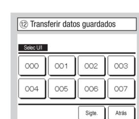
Seleccione la unidad interior a la que desea transferir los datos guardados; aparecerá la pantalla de confirmación Transferir datos guardados. Toque [Si] para transferir los datos.
