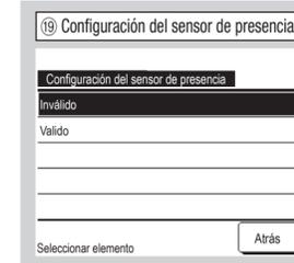
Seleccione [Válido] / [Inválido] para el sensor de presencia de la unidad interior conectada al M/D.
