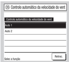
Configure o intervalo de comutação do selector do ventilador na configuração de velocidade automática do ventilador.
