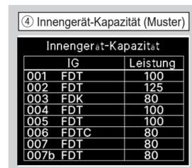
Die Kapazitäten der an die Fernsteuerung angeschlossenen IUs werden angezeigt.
