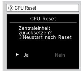
Die Mikrocomputer der angeschlossenen IU und OU werden zurückgesetzt. (Stand der Wiederherstellung nach einem Stromausfall.)
