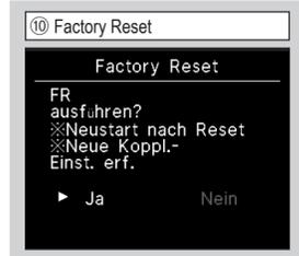
Die Einstellungen der Fernbedienung und der angeschlossenen IUs werden initialisiert. (auf die Werkseinstellungen zurückgesetzt)
