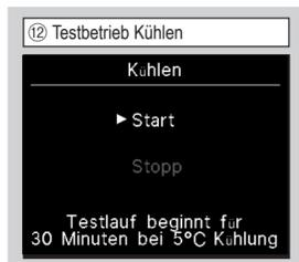
Diese Funktion steht zur Verfügung, wenn der Kühlbetrieb gestoppt wurde. Wenn die Raumtemperatur zu niedrig ist, um „Testbetrieb Kühlen“ zu starten, läuft das Gerät 30 Minuten lang und senkt die Solltemperatur auf 5 °C.
