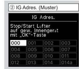
Wenn die Taste **☰** nach der Auswahl einer IU-Adresse angeklippt wird, kann der Ventilator der ausgewählten IU bedient werden. Tippen Sie **☰** auf die Taste wieder, um den Vorgang zu stoppen.
