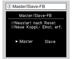
Mit dieser Funktion lässt sich die Konfiguration als Master-/Slave-Fernbedienung ändern.
