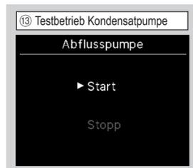
Die Kondensatpumpe kann unabhängig betrieben werden.
