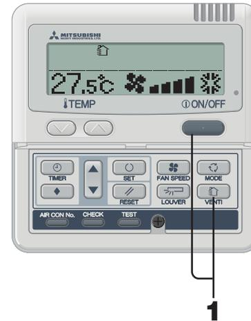
**VENTILATIONSBETRIEB UNABHÄNGIG VOM BETRIEB DER EINHEIT**
