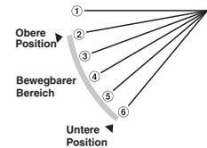
Hinweis: Werden für das obere und untere Limit gleiche Zahlen gewählt, wird die Luftklappe in dieser Position fixiert. Automatisches Schwenken funktioniert dann nicht.
