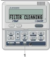
El mensaje "FILTER CLEANING" aparecerá en la pantalla cuando el número de horas de funcionamiento alcance el límite predeterminado con el fin de notificar que el filtro debe limpiarse.
