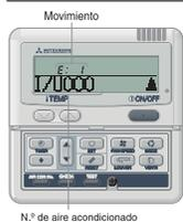
El aire acondicionado se detiene en el caso de que ocurra cualquier problema. Al mismo tiempo el indicador de comprobación parpadea en rojo y el código de error se muestra en la pantalla temporizador ON (encendido) y la pantalla muestra lo siguiente.
