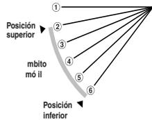
Comentario: Si los números superior e inferior se configuran iguales, el deflector se fija en esa posición. El autobasculante no funciona.
