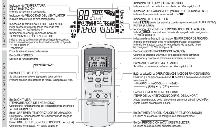
NOTA Si la pantalla del mando a distancia posee errores, presione el botón [REPOSICIÓN (ACL)].
