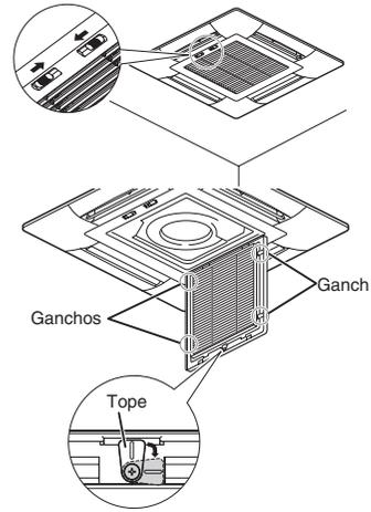
1. Deslice las palancas de la rejilla de entrada en dirección a la flecha (→) y ábrala hacia abajo.
