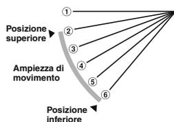
Nota : Se i numeri di quello superiore e inferiore coincidono, il deflettore è fissato ad una posizione. E la funzione di oscillazione automatica non funziona.
