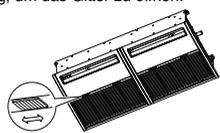
2. Heben Sie den Filter durch leichten, nach oben gerichteten Druck von den Kerben links und rechts und ziehen Sie ihn nach vorn.
