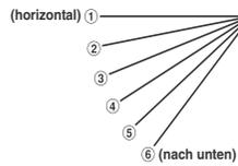
die Position der Luftklappe
