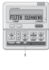
Die Meldung „FILTER CLEANING“ wird angezeigt, wenn die Betriebsstunden eine vorgegebene Stundenzahl erreicht haben, zu der Sie über die erforderliche Filterreinigung benachrichtigt werden.
