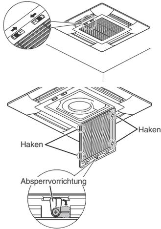
1. Schieben Sie die Hebel des Einlassgitters in Pfeilrichtung (→), und öffnen Sie es nach unten hin.
