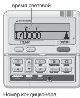
■ Кондиционер останавливается в случае возникновения неполадки. В это же время световой индикатор проверки мигает красным, в зоне дисплея таймера ВКЛ отображается код ошибки, а на дисплее сообщений отображается следующее.
