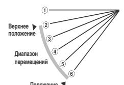
Примечание : Если номера верхнего и нижнего положения совпадают, то жалюзи фиксируются в этом положении. Функция автоматического покачивания не работает.
