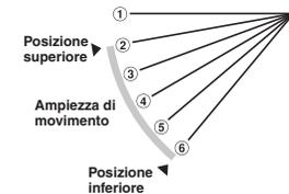
Nota : Se i numeri di quello superiore e inferiore coincidono, il deflettore è fissato ad una posizione. E la funzione di oscillazione automatica non funziona.
