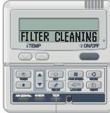
Sul display viene visualizzato "FILTER CLEANING" se la somma delle ore di funzionamento dell'unità interna raggiunge il numero di ore per il quale è stato impostato un messaggio di notifica di pulizia dei filtri.
