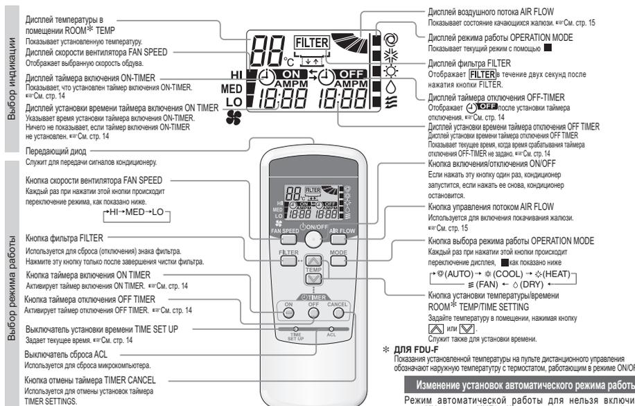
Изменение установок автоматического режима работы. Режим автоматической работы для нельзя включить для KX (кроме KXR). Когда для данного устройства выбран автоматический режим работы, отключите автоматический режим с пульта дистанционного управления. Удерживая нажатой кнопку [MODE], нажмите на переключатель [ACL] либо удерживая нажатой кнопку [MODE], вставьте в пульт дистанционного управления батарейки, после чего режим автоматической работы будет отменен.
