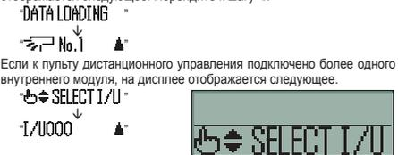
Если к пульту дистанционного управления подключено более одного внутреннего модуля, на дисплее отображается следующее.
