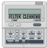
Отображается "FILTER CLEANING", когда совокупное время работы достигает predetermined установленного числа часов, чтобы напомнить о том, что пора почистить фильтр.
