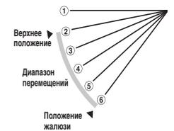
Примечание : Если номера верхнего и нижнего положения совпадают, то жалюзи фиксируются в этом положении. Функция автоматического покачивания не работает.
