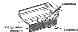
Устанавливая фильтр, зафиксируйте его в защелках впускной решетки.
