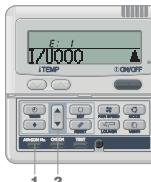
1 Нажмите кнопку AIR CON No. Выполняется переход в режим отображения AIR CON No. и отображается состояние AIR CON для наименьшего номера. Другие области отображения отключаются.
