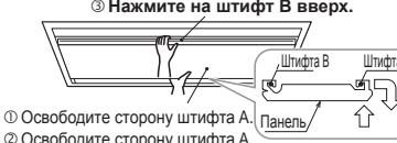
4. Нажмите на воздушный фильтр и поверните фиксатор, чтобы снять воздушный фильтр.
