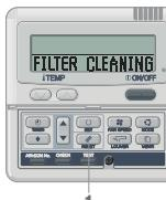
Отображается "FILTER CLEANING", когда совокупное время работы достигает предварительно установленного числа часов, чтобы напомнить о том, что пора почистить фильтр.
