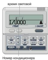
■ Кондиционер останавливается в случае возникновения неполадки. В это же время световой индикатор проверки мигает красным, в зоне дисплея таймера ВКЛ отображается код ошибки, а на дисплее сообщений отображается следующее.
