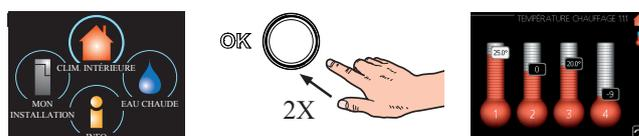
Le mode de réglage de la température intérieure est accessible en appuyant deux fois sur le bouton OK, en mode de démarrage dans le menu principal. Pour en savoir plus sur les réglages, allez à la page 14.
