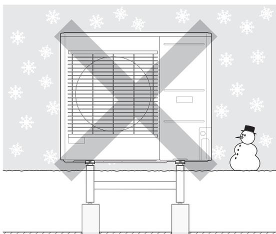
Empêchez la neige de s'accumuler et de recouvrir les grilles et les trous de drainage de la FDCW.
