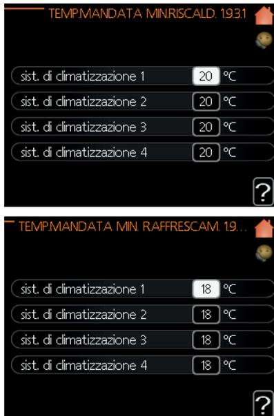
\*Se c'è un solo impianto di climatizzazione, il display mostra solo "sistema di climatizzazione 1".
