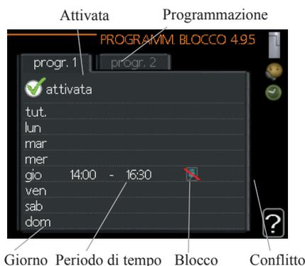
Quando la programmazione è attiva, nel menu principale viene visualizzato il relativo simbolo di blocco in corrispondenza del simbolo del modulo di controllo.
