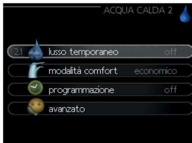
**“lusso temporaneo”** Attivazione di un aumento temporaneo della temperatura dell’acqua calda. Le informazioni sullo stato indicano “off” o il tempo rimanente di aumento temporaneo della temperatura.
