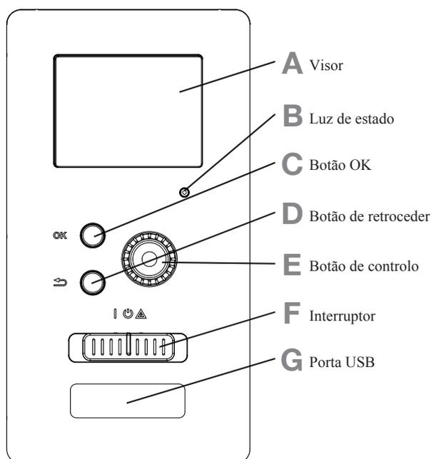
Há uma unidade de visualização na parte frontal do módulo de controlo, que é usada para comunicar com o RC-HY20/40-W. Nela poderá:
