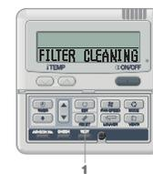
Die Meldung „FILTER CLEANING“ wird angezeigt, wenn die Betriebsstunden eine vorgegebene Stundenzahl erreicht haben, zu der Sie über die erforderliche Filterreinigung benachrichtigt werden.
