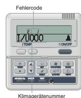
Die Klimaanlage wird bei Auftreten eines Fehlers gestoppt. Gleichzeitig blinkt die Prüfanzzeige rot auf, und der Fehlercode erscheint im On-Timer-Anzeigebereich sowie folgende Meldung:
