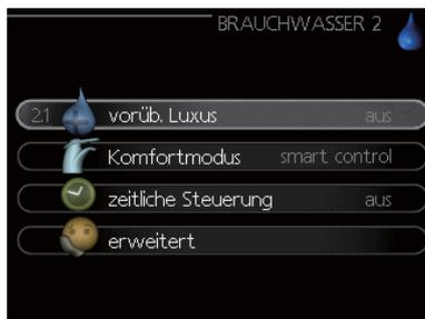
**„Vorüb. Luxus“** Zur Aktivierung einer vorübergehenden Erhöhung bei der Brauchwassertemperatur. Als Status-Informationen wird entweder „aus“ angezeigt oder die verbleibende Restzeit für die vorübergehende Temperaturerhöhung.
