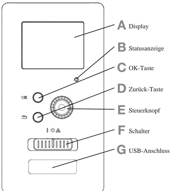
Auf der Vorderseite des Steuergeräts befindet sich ein Display, mit dem Sie RC-HY20/40-W bedienen können. Sie können hier:
