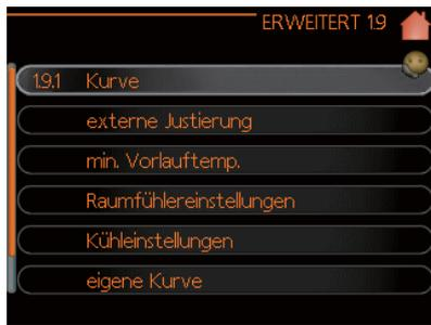
Das Menü „Erweitert“ wird in orange angezeigt und ist für den fortgeschrittenen Anwender gedacht. Dieses Menü hat mehrere Untermenüs.
