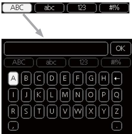
Je nach Menü erhalten Sie Zugang zu verschiedenen Zeichensätzen, die Sie mit dem Steuerknopf auswählen können. Um den Zeichensatz zu ändern, drücken Sie die Zurück-Taste. Falls ein Menü nur einen Zeichensatz erfordert, wird die Tastatur sofort angezeigt.
