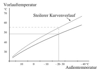
Die optimale Kurvensteigung hängt von den klimatischen Gegebenheiten Ihres Standorts ab, von der Art der Heizelemente (Heizkörper oder Fußbodenheizung) und davon, wie gut das Haus isoliert ist.
