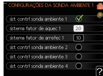
\*Se houver um sistema de climatização, o visor mostra apenas "control room sensor system 1".
