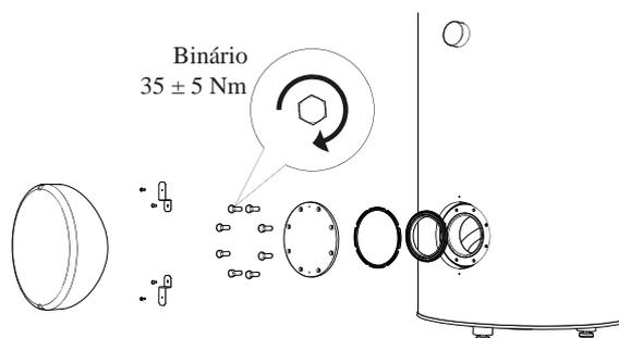
Instalação da tampa da abertura de inspeção (ordem de montagem).
