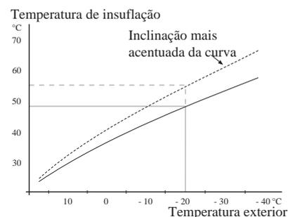
A inclinação ideal depende das condições climáticas do local em que se encontra, do tipo de dispositivo de aquecimento (radiadores ou piso radiante) e do nível de isolamento da casa.
