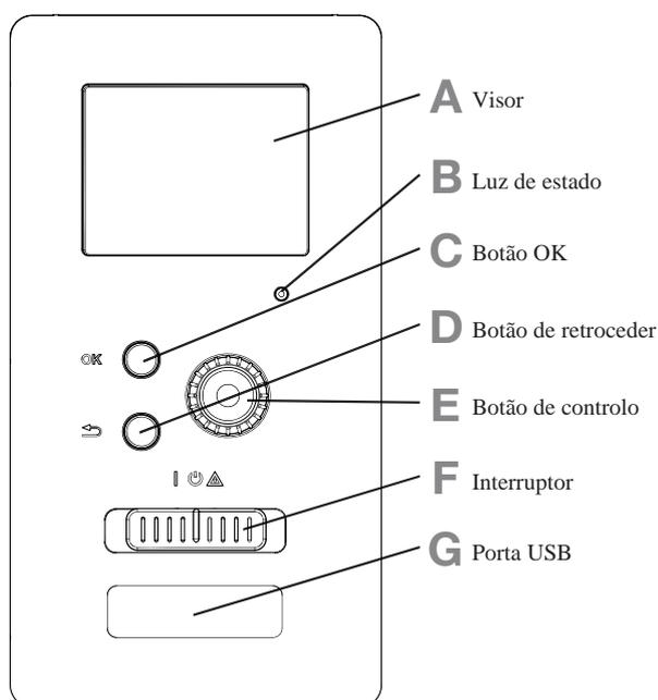
Há uma unidade de visualização na parte frontal do controlador, que é usada para comunicar com o RC-HY20/40-W. Nela poderá:
