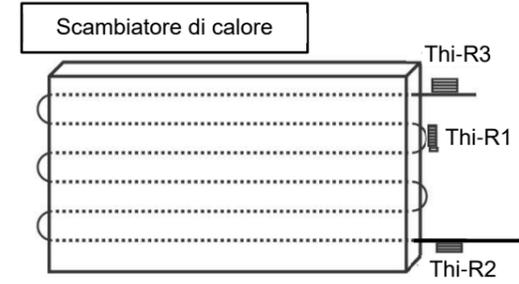
Ciascun sensore ha una funzione specifica. È importante determinare il posizionamento corretto. Se fissato in posizione errata, il sistema non potrà essere controllato correttamente; controllare due volte durante la messa in esercizio. Il diametro del sensore Thi-R3 è maggiore degli altri per evitare errori.
