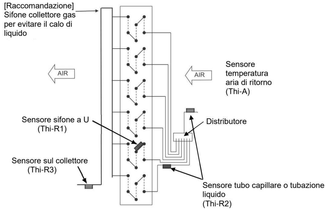
Funzione di ciascun sensore dello scambiatore di calore
