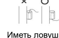
4. Дренажная вода не проникает в соединительную часть блока управления через провод датчика (защитная трубка).
