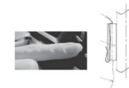
9. Los sensores no deben montarse en una posición en la que se acumule el agua de drenaje.
