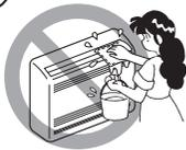
• Berühren Sie die Aluminiumlamellen am Wärmetauscher nicht.
