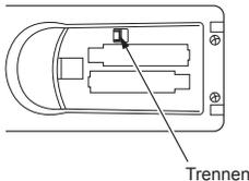
**3** Batterien einsetzen. Die Abdeckung schließen.
