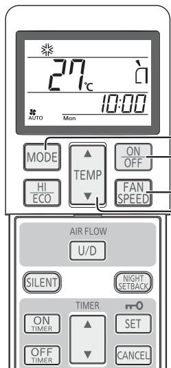
Операция регулирования направления воздушного потока.
