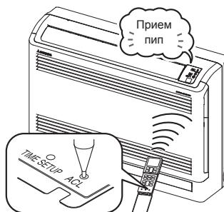
**3** Проследите за тем, чтобы зуммер приема во внутреннем модуле подал звуковой сигнал "пип".
