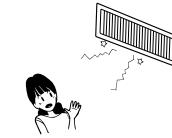
Если наблюдается ненормальная работа устройства, немедленно отключите питание и снова включите его через 3 минуты. Устройство продолжает работать ненормально даже после его перезапуска с помощью кнопки ON/OFF (вкл/выкл) на пульте дистанционного управления.
