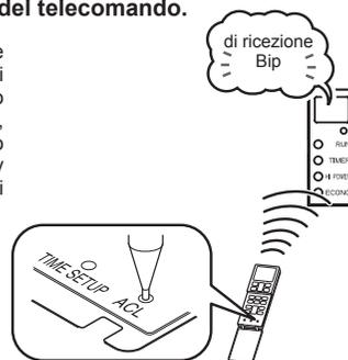
**3** Controllare che l'unità interna emetta un segnale acustico ("bip") di ricezione.
