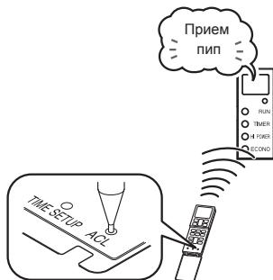
**3** Проследите за тем, чтобы зуммер приема во внутреннем модуле подал звуковой сигнал "пип".
