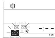
Когда установки заданы (ON-TIMER (таймер включения) или OFF-TIMER (таймер выключения)), индикатор таймера и отображается постоянно.
