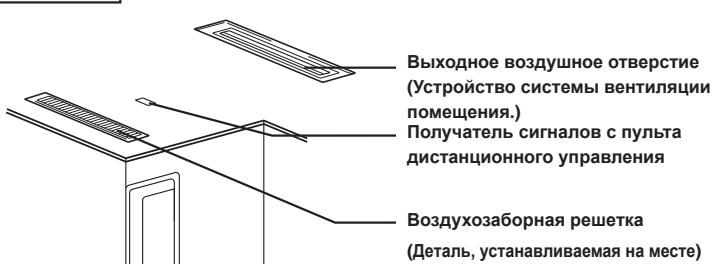
Выходное воздушное отверстие (Устройство системы вентиляции помещения.)
