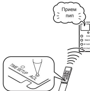
**3** Проследите за тем, чтобы зуммер приема во внутреннем модуле подал звуковой сигнал "пип".
