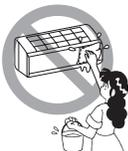
No toque las aletas de aluminio del intercambiador de calor. Apóyese firmemente en una escalera o en algún otro objeto estable al extraer el filtro y el panel de entrada.
