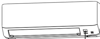
Кнопка ВКЛ/ВЫКЛ на приборе
