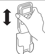
Для установки или снятия пульта дистанционного управления поднимите его или опустите его в держатель.
