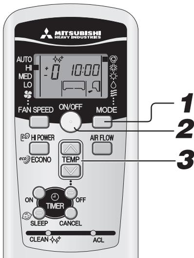
• Если вы не хотите пользоваться программой AUTO (автоматический режим работы), поменяйте ее на COOL (охлаждение), HEAT (отопление) или FAN (вентиляция).
