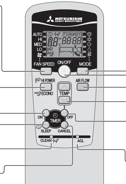
**Botón de FAN SPEED (VELOCIDAD DEL VENTILADOR)**
