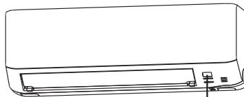
Кнопка ВКЛ/ВЫКЛ на приборе
