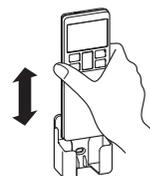
Pour sortir et remettre la télécommande, il suffit de la glisser le long du porte-télécommande.
