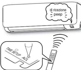
**3** Controllare che l'unità interna emetta un segnale acustico ("peep") di ricezione.
